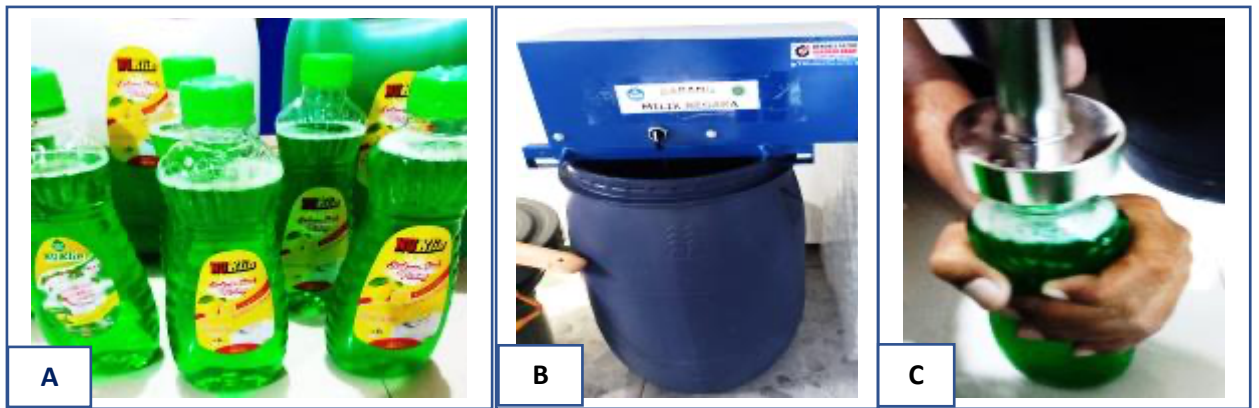
Gambar 4. Produk Sabun Cair NU Klin dan Alat Teknologi Tepat Guna ; (a) sampel produk sabun cair NU Klin, (b) Alat TTG (Mesin Mixing Movable Liquid ), (c) Manual capper untuk kemasan perekat tutup botol sabun NU Klin
