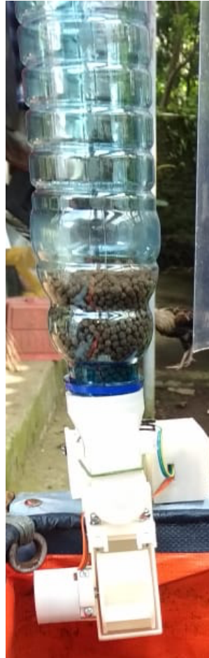
Gambar 1. Pengumpan Ikan dengan Mekanisme Pelemparan Portabel
